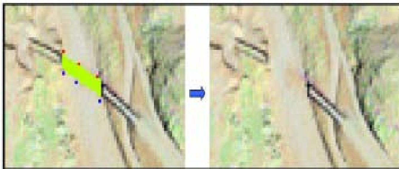
Figura 22.- Eliminación de puentes
